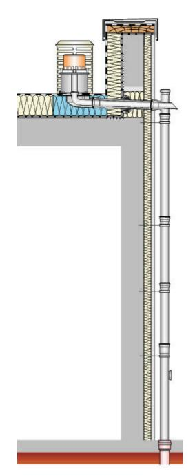
**1.2** Fallleitung unter jeder Muffenverbindung mit LORO-X Rohrschellen DN 100 fixieren.
